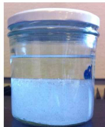
Figur 3. Lagdeling i underafkølet salt
