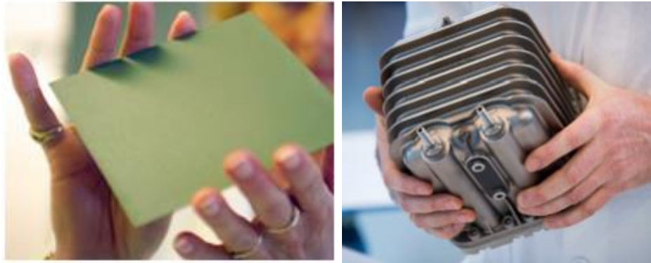
Figur 1. En fastoxid celle og stak. Fra Haldor Topsoe A/S.
