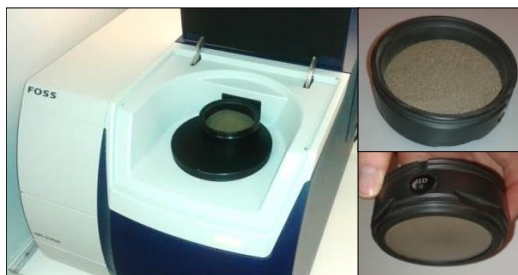
Figur 2. Vis-NIR spektrometer samt beholder til jordprøven med glasvindue.
